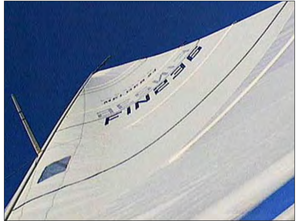
Isopurje on latistettu kovaan tuuleen mastoa taivuttamalla.
